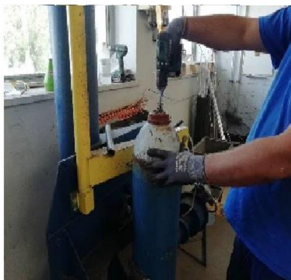
Rys. 2 Czyszczenie gwintu szyjki butli
